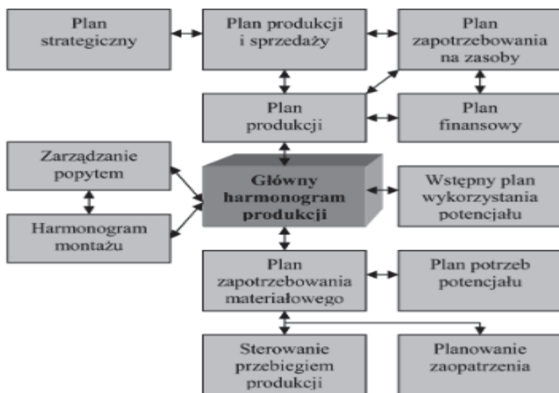
Rysunek 1. Typowa struktura procesów planowania w przedsiębiorstwie produkcyjnym
