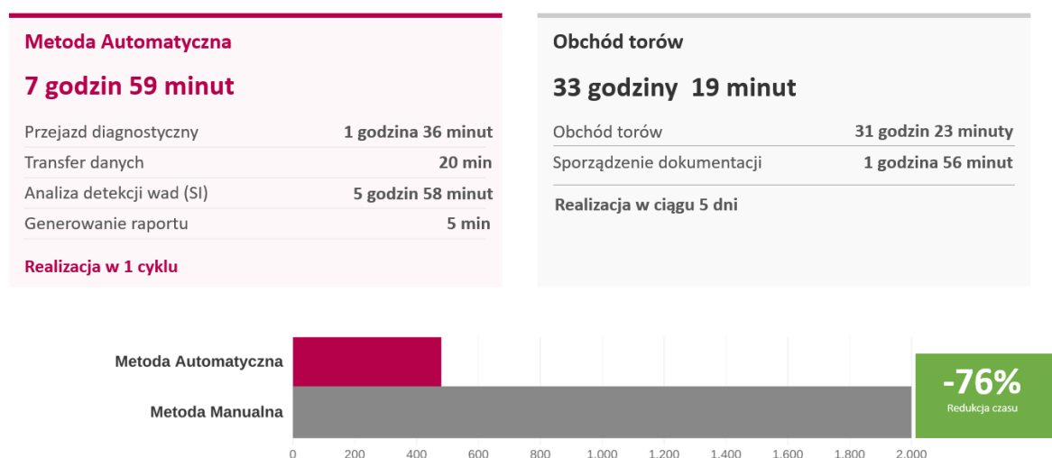
Rysunek 15 Porównanie czasu inspekcji metody automatycznej oraz tradycyjnej
