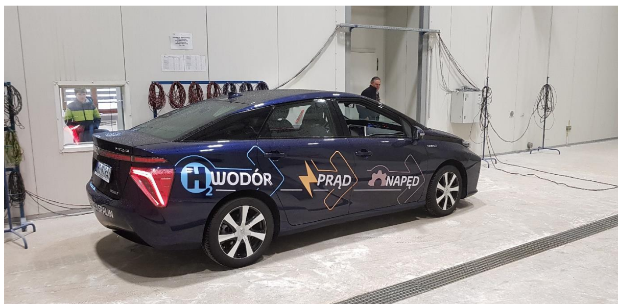
Toyota Mirai I podczas badań w komorze technoklimatycznej Politechniki Krakowskiej (Kraków 2019 r)
