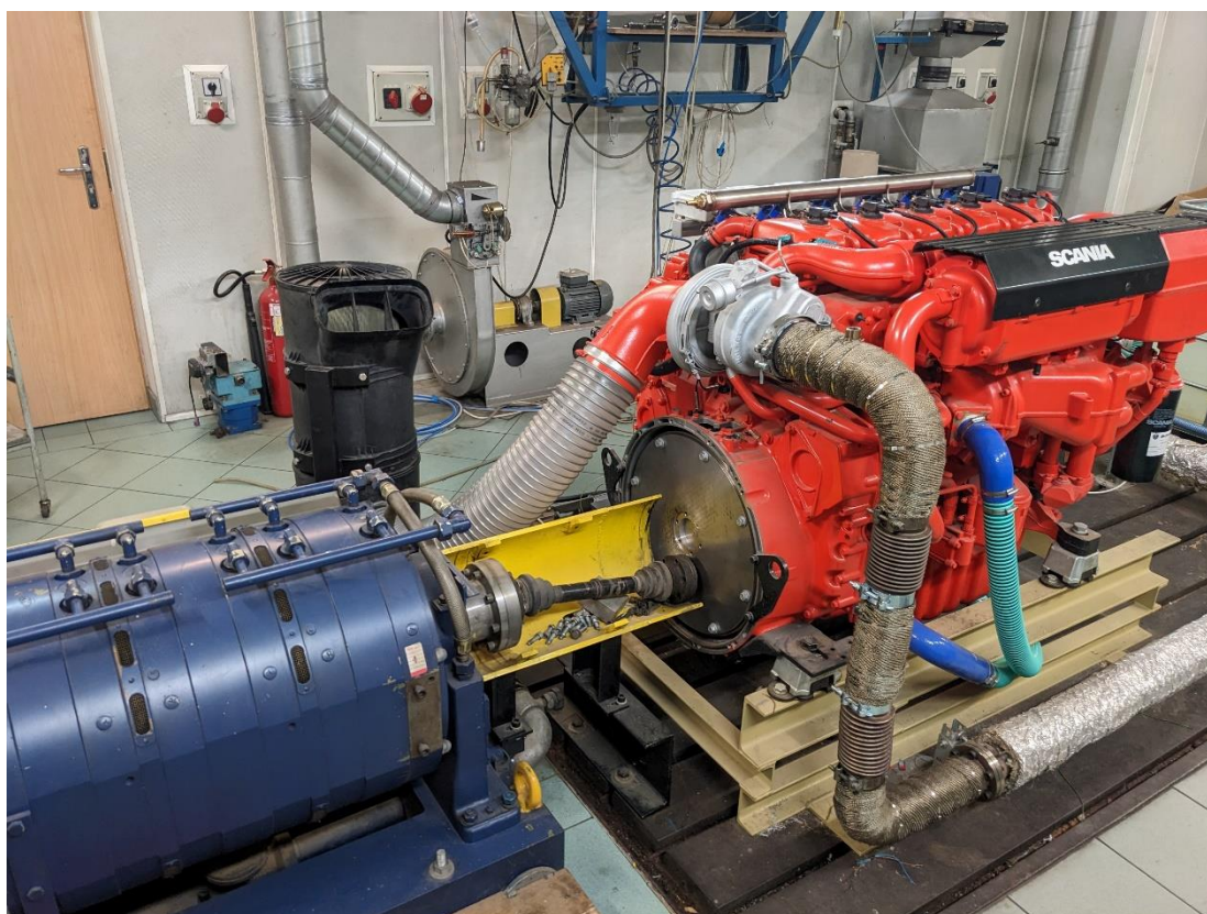
Przemysłowy silnik tłokowy dostosowany do zasilania wodorem
