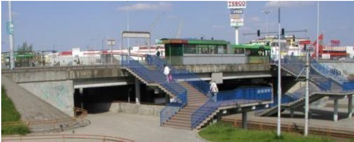
Rys. 4. Przesiadka między autobusami (jadącymi górą) a poprzeczną do nich trasą tramwajową Poznańskiego Szybkiego Tramwaju (dołem), bez miejsca na pętlę.
