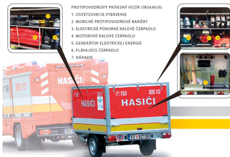
Obrázok 13. Umiestnenie vecných prostriedkov v protipovodňovom vozíku
